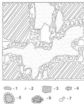
**Рисунок 10** Структура затвердевшего раствора
